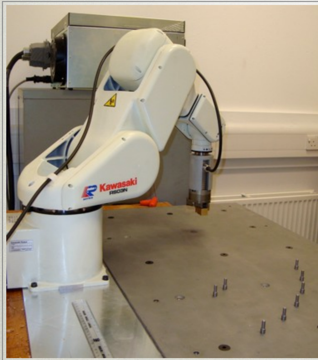
Clavijas posicionadas en dos semicírculos con centro en la base del robot, de radios 24.45 y 40 cm
