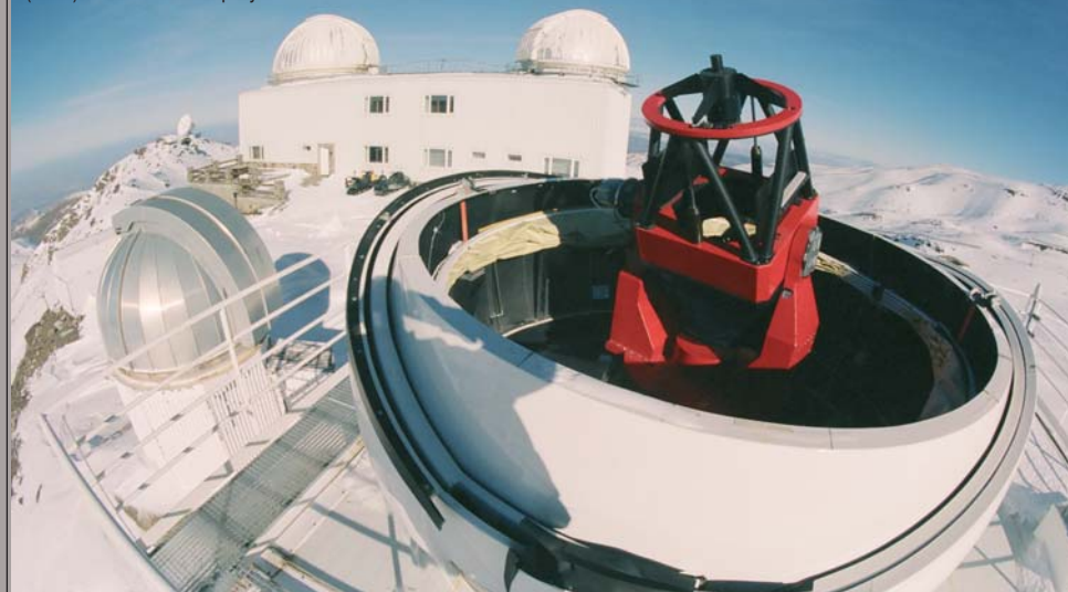
Telescopio robótico infrarrojo de 60 cm dedicado al estudio de explosiones de rayos gamma (GRB) en el marco del proyecto Bootes-IR.
