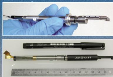
Izda. Grupo de 19 robots diseñados para el Gran Telescopio Canarias. Arriba, robot de 12 mm de diámetro para BigBOSS. Debajo, el robot de 7.4 mm desarrollado para el instrumento DESI.
