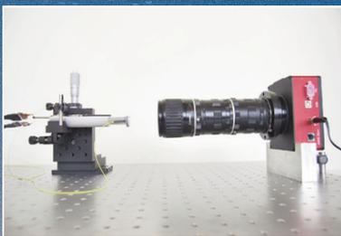
Vista lateral de la configuración óptica utilizada para la automatización del proceso de prueba del posicionador de fibra óptica construido para el instrumento DESI.
