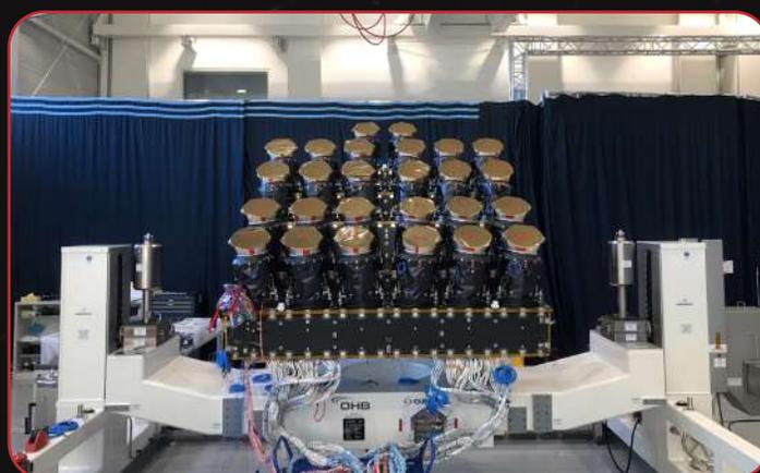
Módulo de carga útil de PLATO en proceso de integración en la sala blanca de OHB System AG. Crédito: OHB
