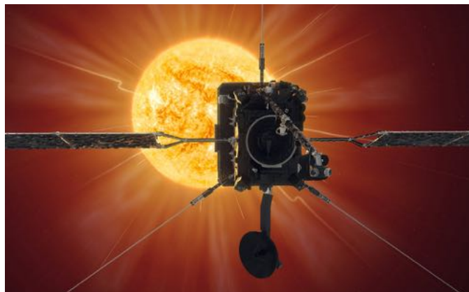
Solar Orbiter cuenta con un conjunto de diez instrumentos científicos para estudiar el Sol. Los hay de dos tipos: in situ, que miden las condiciones que rodean a la propia nave espacial, y de teledetección, que miden lo que ocurre a grandes distancias. Juntos, ambos conjuntos de datos pueden utilizarse para obtener una imagen más completa de lo que ocurre en la corona y el viento solares. Crédito: ESA/ATG medialab
