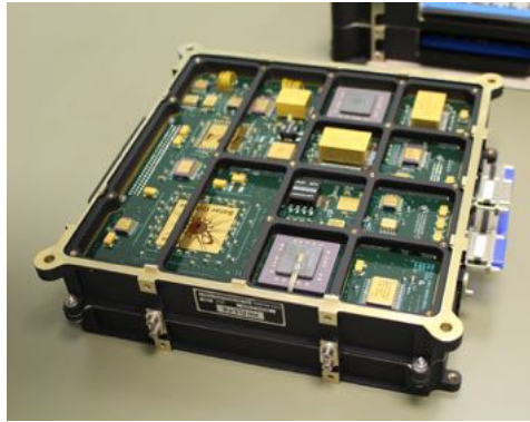
A la izquierda, modelo de vuelo de la DPU de ExoMars antes de su integración. Crédito: GIES A la derecha, vista de las FPGAs en PHI, ya integradas en el modelo de vuelo: Crédito: SPG
